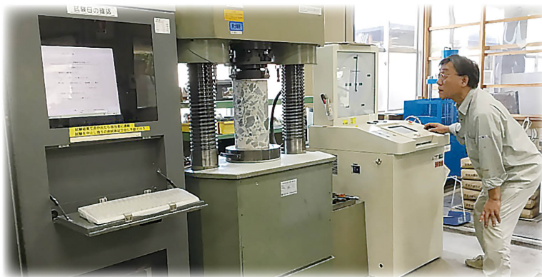
コンクリートの強度試験
