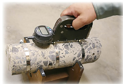
コンクリートコアの膨張量測定
