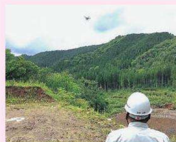
ドローンによる空中写真測量
