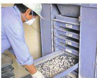
路盤材のふるい分け試験(碎石を大きさ別に選別します)
