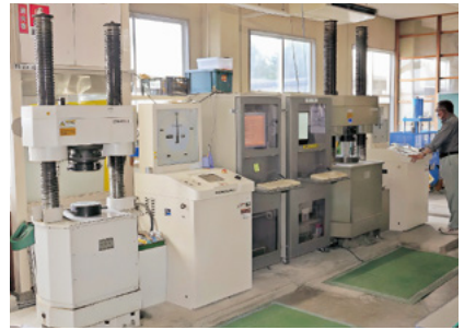
コンクリート試験室（圧縮試験機）
