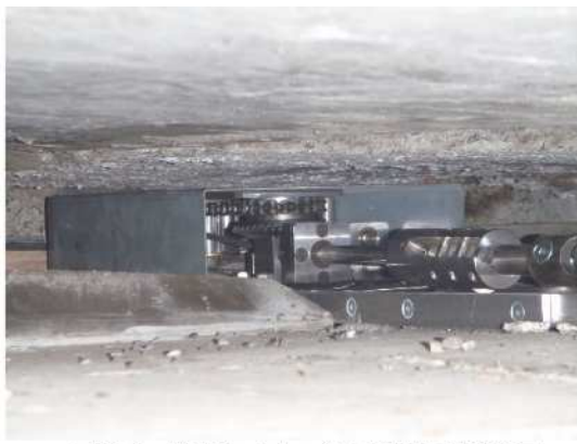
写真3 塩化物イオン含有量測定試料採取
