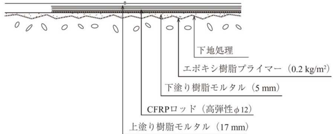
CFRP ロッド工法概念図
