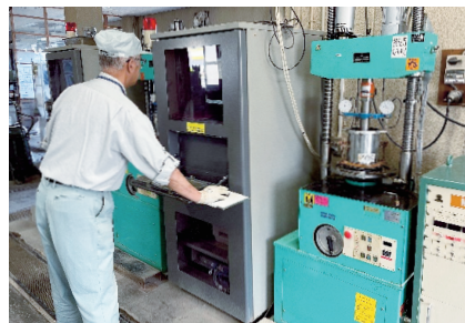
修正CBR試験 (買入試験) (CBR試験機)
