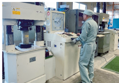
コンクリート圧縮試験 (圧縮試験機)
