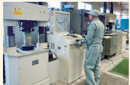
コンクリート圧縮試験（圧縮試験機）
